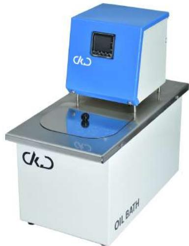
حمام کالیبراسیون مدل DK-250 با گستره دمایی ۲۵ تا ۲۵۰ درجه سانتی گراد و پایداری ۰.۲ درجه سانتی گراد و ریزنگری ۰.۱ درجه سانتی گراد به همراه یک دستگاه مرجع در آزمایشگاه دما مورد استفاده قرار میگیرد. و همچنین می توان به عنوان دستگاهی پرتابل و سبک جهت کار در محل مشتری مورد استفاده قرارگیرد.
