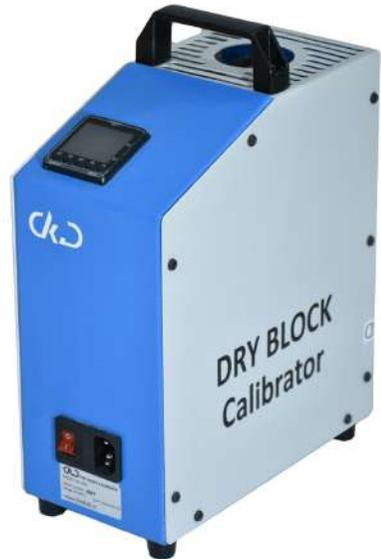
کوره کالیبراسیون مدل DK-600 با گستره دمایی ۲۵ تا ۶۰۰ درجه سانتی گراد و پایداری ۰.۲ درجه سانتی گراد و ریزنگری ۱ درجه سانتی گراد به همراه یک دستگاه مرجع در آزمایشگاه دما مورد استفاده قرار میگیرد. و همچنین می توان به عنوان دستگاهی پرتابل و سبک جهت کار در محل مشتری مورد استفاده قرار گیرد.
